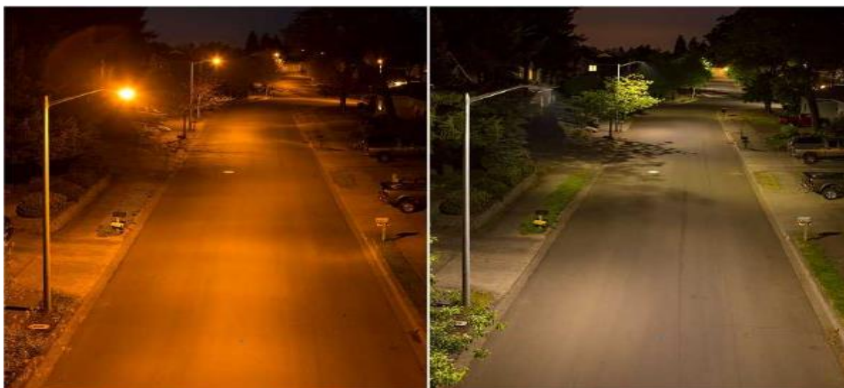
Fig. 1.2. Comparație între sistem de iluminat cu vapori de sodiu de înaltă presiune și sistem de iluminat cu LED
