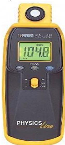
Fig. 3.1. Luxmetrul digital Chauvin Arnoux CA 811
