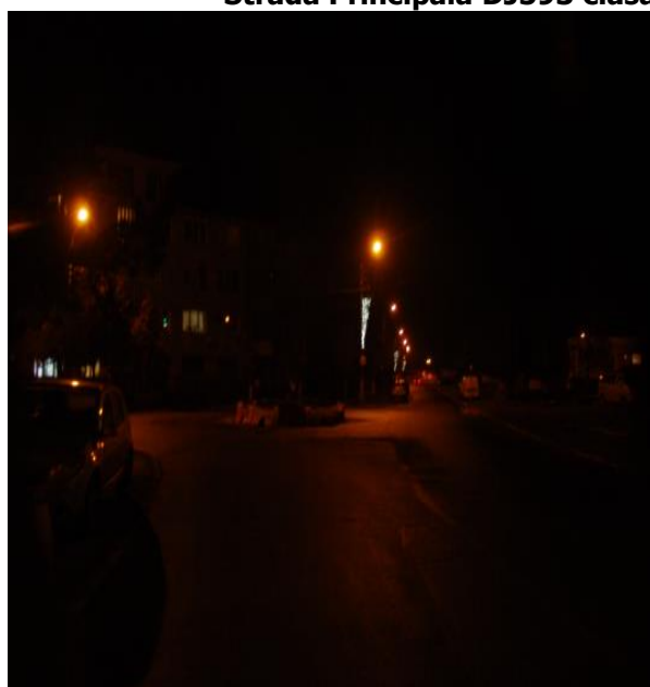
Centru intersecție DN 59B-clasa M5 Luminanțe insuficiente, cca 0,25 cd/m 2
